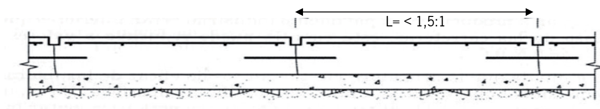
Gráfico 3.- Detalles de la armadura con mallazo y la correcta ejecución de juntas de contracción (L y e)
